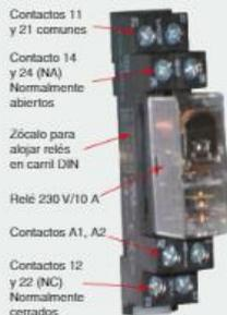
Figura 9.38. Relé industrial conmutado doble.
