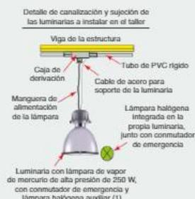
(1) Debido a la actividad del taller, es imprescindible que las luminarias posean una lámpara auxiliar halógena. Esto permitirá que, en casos de suministro, cuando se restablezca de nuevo la alimentación, la nave quede iluminada por esta lámpara hasta que la lámpara principal (lámpara de vapor de mercurio) haya arrancado de nuevo.
