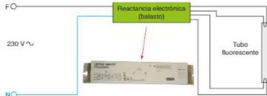
Figura 9.14. Conexión de un tubo fluorescente mediante reactancia electrónica.
