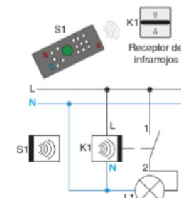
Figura 2.36. Conjunto emisor-receptor para el control de luces a distancia mediante infrarrojos, en el cual el receptor actúa como interruptor manual o bien a través de mando a distancia.
