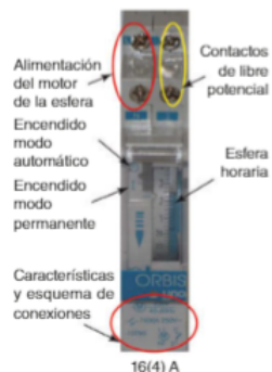
Figura 2.12. Interruptor horario de esfera (ORBIS).
