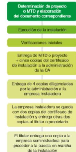
Figura 3.8. Proceso de ejecución, verificación, tramitación y puesta en marcha de una instalación.
