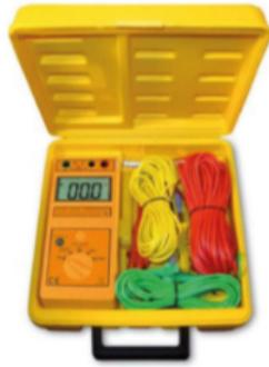
Figura 5.2. Telurómetro.
