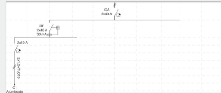
Figura 4.38. Esquema unifilar del CGMP.
