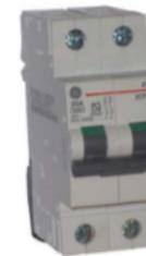
Figura 4.5. Interruptor de Control de Potencia (ICP) bipolar de 20 A, siendo la potencia contratada en la instalación donde se ubique este ICP de 20 · 250 = 4 600 W.
