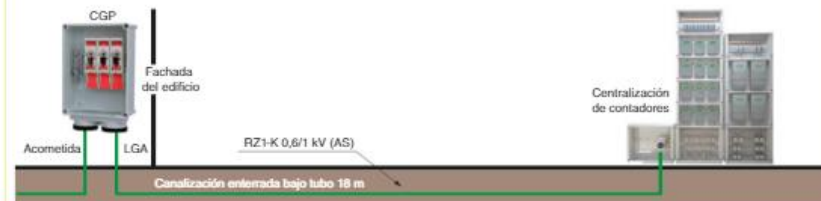
Figura 8.9. Instalación de la línea general de alimentación del edificio.
