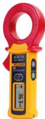
Figura 12.7. Medidor de fuga (FLUKE).
