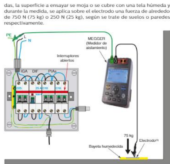
Figura 12.6. Medida de resistencia de paredes y suelos.
