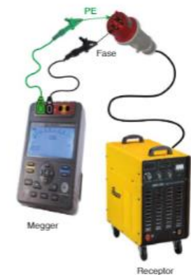
Figura 12.5. Medida de aislamiento de un receptor.
