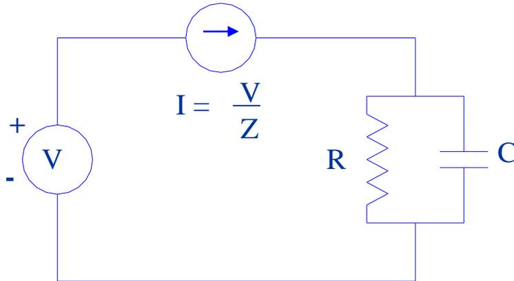
Es importante observar que el **objeto bajo prueba está representado por una resistencia en paralelo con un capacitor**. Esto quiere decir que la corriente que circula por el circuito no sólo depende de la resistencia del aislamiento, sino también de su capacitancia. Estrictamente hablando, la prueba de resistencia de aislamiento debería llamarse prueba de impedancia de aislamiento, ya que existe también un efecto capacitivo.
