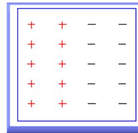
Fig. 2. Polarización de las cargas en presencia del campo eléctrico
